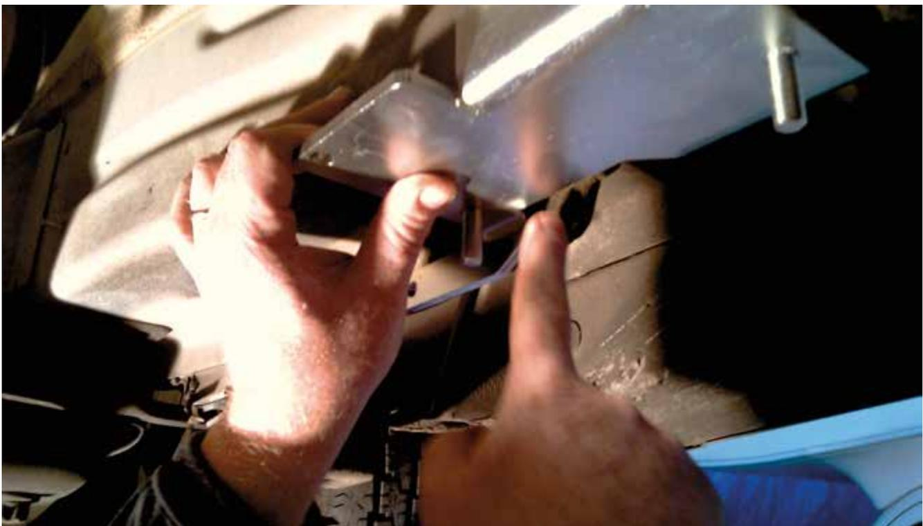
I sjældne tilfælde kan det være nødvendigt at slibe for at opnå korrekt rotation af donkraften
