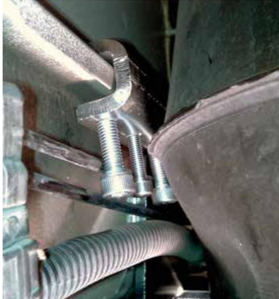
Aseta kiinnitin säiliön ja alustan väliin, kiinnitä huomiota putkiin. Joissakin tapauksissa voi olla tarpeen löysätä hieman säiliön kiinnitysruuveja, jotta säiliötä voidaan siirtää 1-2 cm pois päin alustasta.
