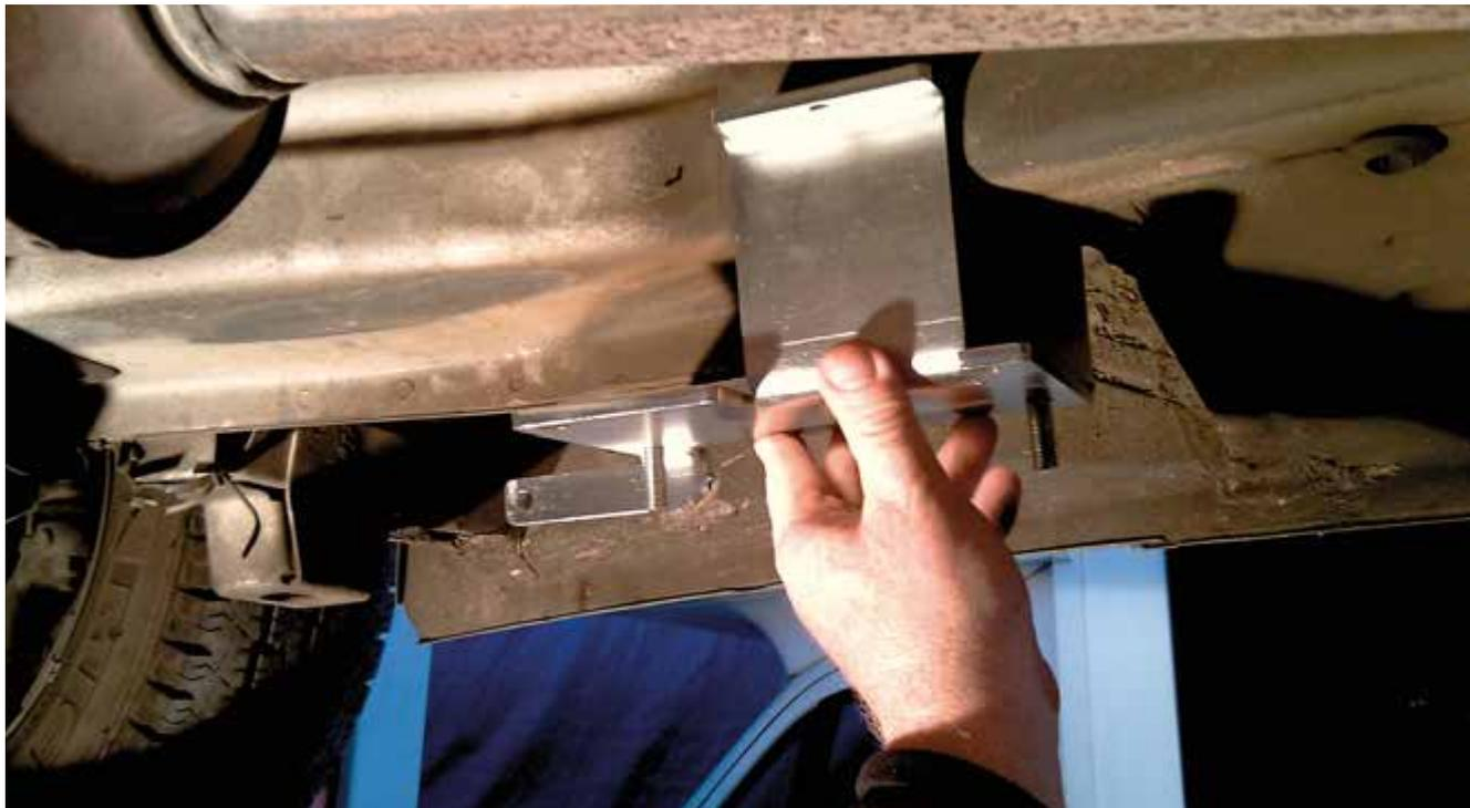
Arretrare il più possibile l'adattatore. Se necessario, rimuovere il materiale sigillante per una maggiore aderenza. Utilizzare un martinetto per fissare la staffa nella posizione corretta e praticare un foro laterale di 8 mm, quindi fissarlo con un bullone.
