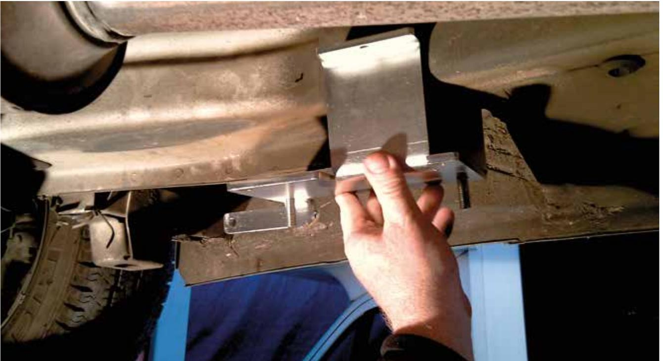
Placez l'adaptateur le plus en arrière possible. Si nécessaire, enlevez le matériau d'étanchéité pour une meilleure adhérence. Utilisez un cric de bouteille pour fixer le support dans la bonne position et faites un trou latéral de 8 mm, puis fixez-le avec un boulon.
