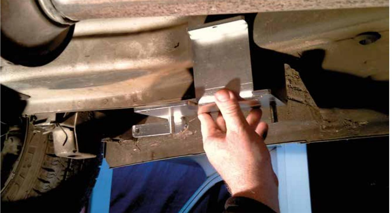
Aseta sovitin mahdollisimman kauas taakse. Tarvittaessa poista mahdollinen tiivistemateriaali paremman kiinnittymisen varmistamiseksi. Kiinnitä kiinnike oikeaan asentoon pullotunkilla ja tee 8 mm:n sivureikä ja kiinnitä se sitten pultilla.
