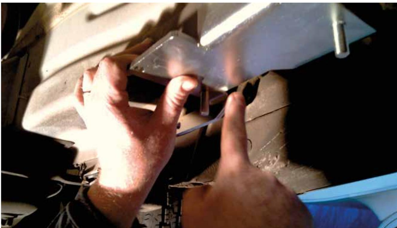
I sällsynta fall kan det vara nödvändigt att slipa i syfte att uppnå en korrekt rotation av domkraften
