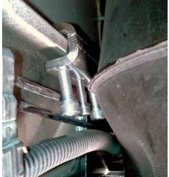
Colocar la abrazadera entre el depósito y el chasis, prestando atención a los tubos. En algunos casos puede ser necesario aflojar ligeramente los tornillos que fijan el depósito, para alejarlo del chasis 1-2 cm.
