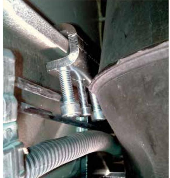
Bringen Sie die Schelle zwischen dem Tank und dem Fahrgestell an, achten Sie dabei auf die Rohre. In manchen Fällen kann es notwendig sein, die Schrauben zur Befestigung des Tanks leicht zu lösen, um ihn 1-2 cm vom Fahrgestell zu entfernen.
