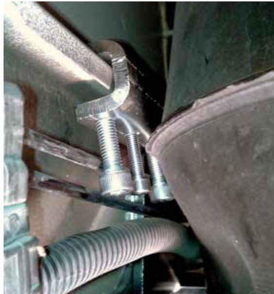
Posizionare il morsetto tra il serbatoio e il telaio, facendo attenzione ai tubi. In alcuni casi potrebbe essere necessario allentare leggermente le viti di fissaggio del serbatoio, per allontanarlo dal telaio di 1-2 cm.
