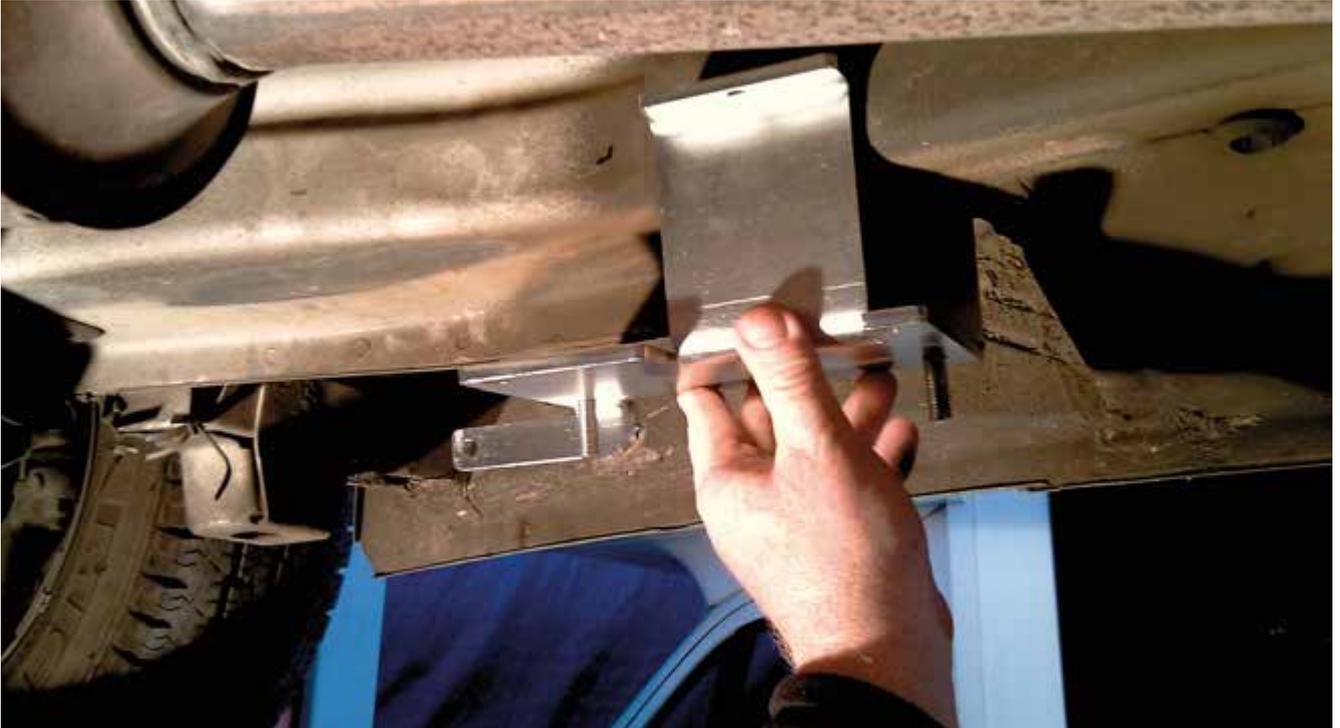
Sæt adapteren så langt tilbage som muligt. Fjern om nødvendigt tætningsmateriale for at opnå bedre vedhæftning. Brug en donkraft til at fastgøre beslaget i den korrekte position og lav et 8 mm hul i siden, og fastgør det derefter med en bolt.
