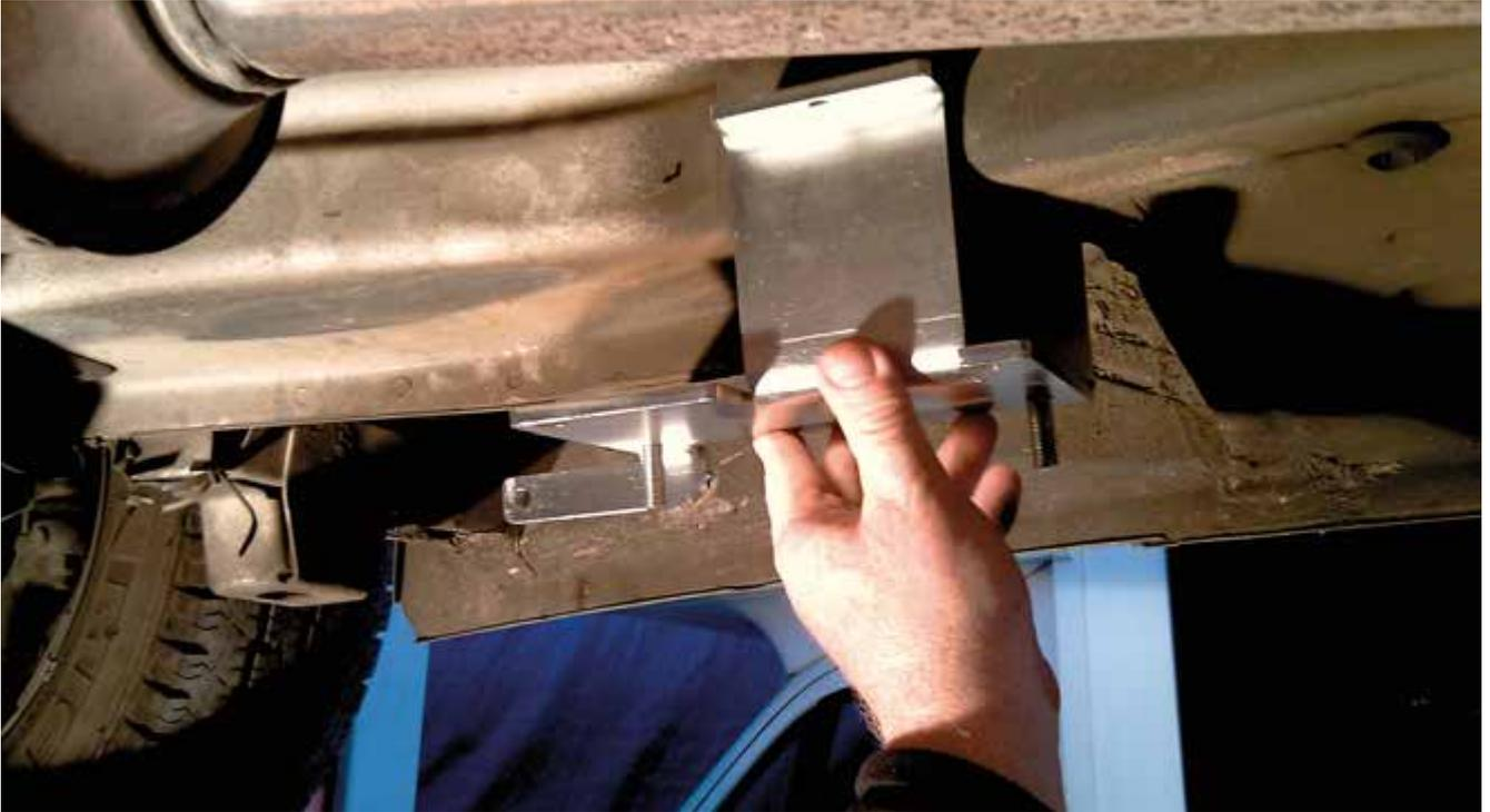
Coloque el adaptador lo más atrás posible. Si es necesario, retire el material de sellado para una mayor adherencia. Utilice un gato de botella para fijar el soporte en la posición correcta y haga un agujero lateral de 8 mm, luego fíjelo con un tornillo.
