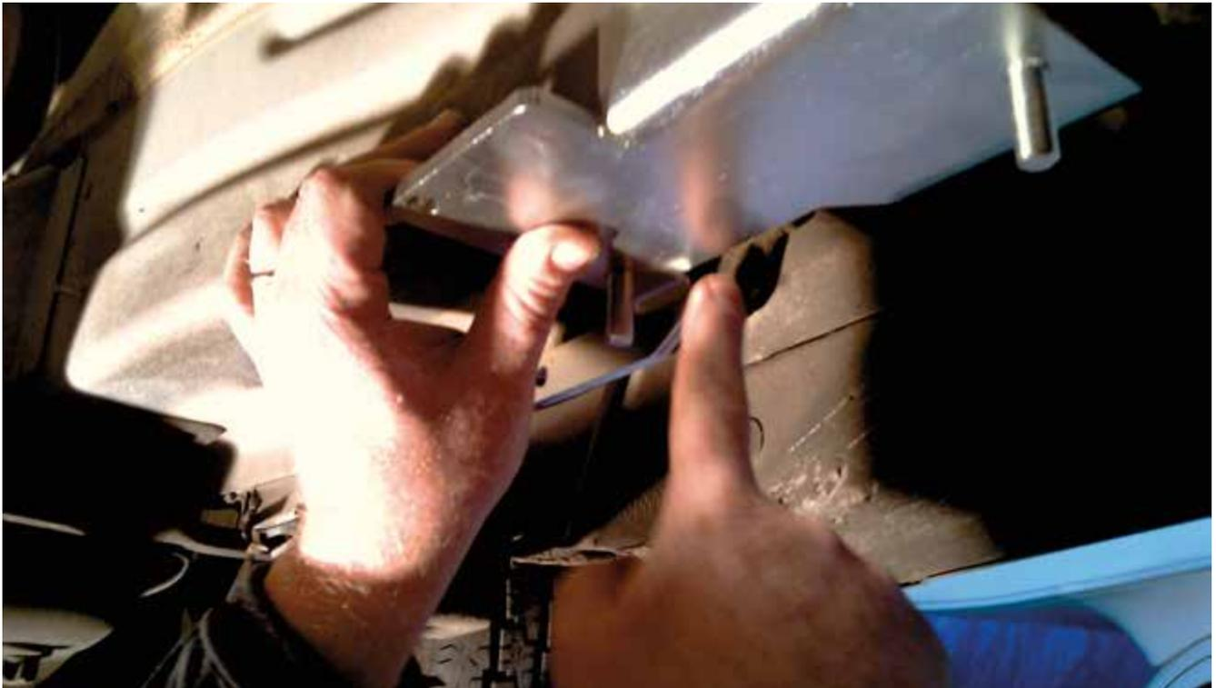
In seltenen Fällen kann es notwendig sein, den Wagenheber abzuschleifen, um eine korrekte Drehung zu erreichen. Achtung! Der Wagenheber muss zur Außenseite des Fahrzeugs gerichtet sein, die Drehung muss nach vorne erfolgen.
